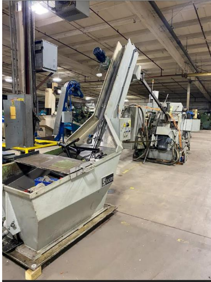
Imagem 02. Lateral da máquina chanfradeira
